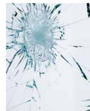
Glasbruch mit VSG (Verbund Sicherheitsglas, splitterbindendes Glas)
