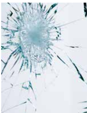
Glasbruch mit VSG (Verbundsicherheitsglas, splitterbindendes Glas)
