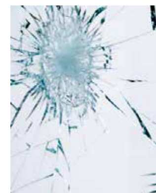
Bris de verre avec VSG (verre feuilleté de sécurité, verre à liaison incassable)
