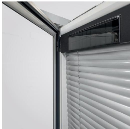
Grazie al modulo fotovoltaico, I-tec shading assicura l'ombreggiatura per una temperatura ambiente ideale – completamente autosufficiente e senza alimentazione aggiuntiva! Grazie alla modalità automatica, le tende si aprono e si chiudono automaticamente all'alba o al tramonto. Il controllo è effettuato da sensori di temperatura incorporati. Ad esempio, il calore della luce del sole può essere sfruttato in modo ottimale in inverno perché le persiane rimangono aperte.
