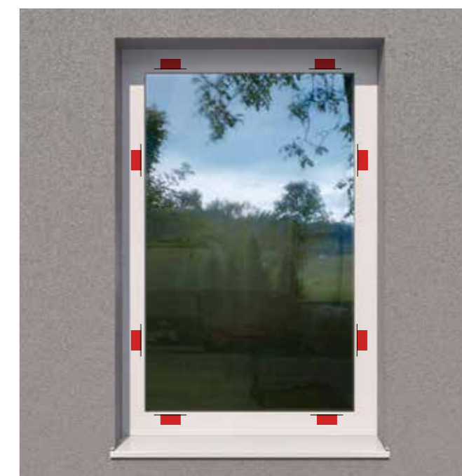
Štandardné usporiadanie uzamykacích bodov I-tec Secure
