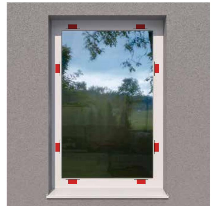
standardni raspored točaka zaključavanja I-tec Secure
