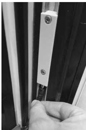
4. Steek de stekker in de oplader. Sluit het raam en sluit de oplader aan op het stopcontact
